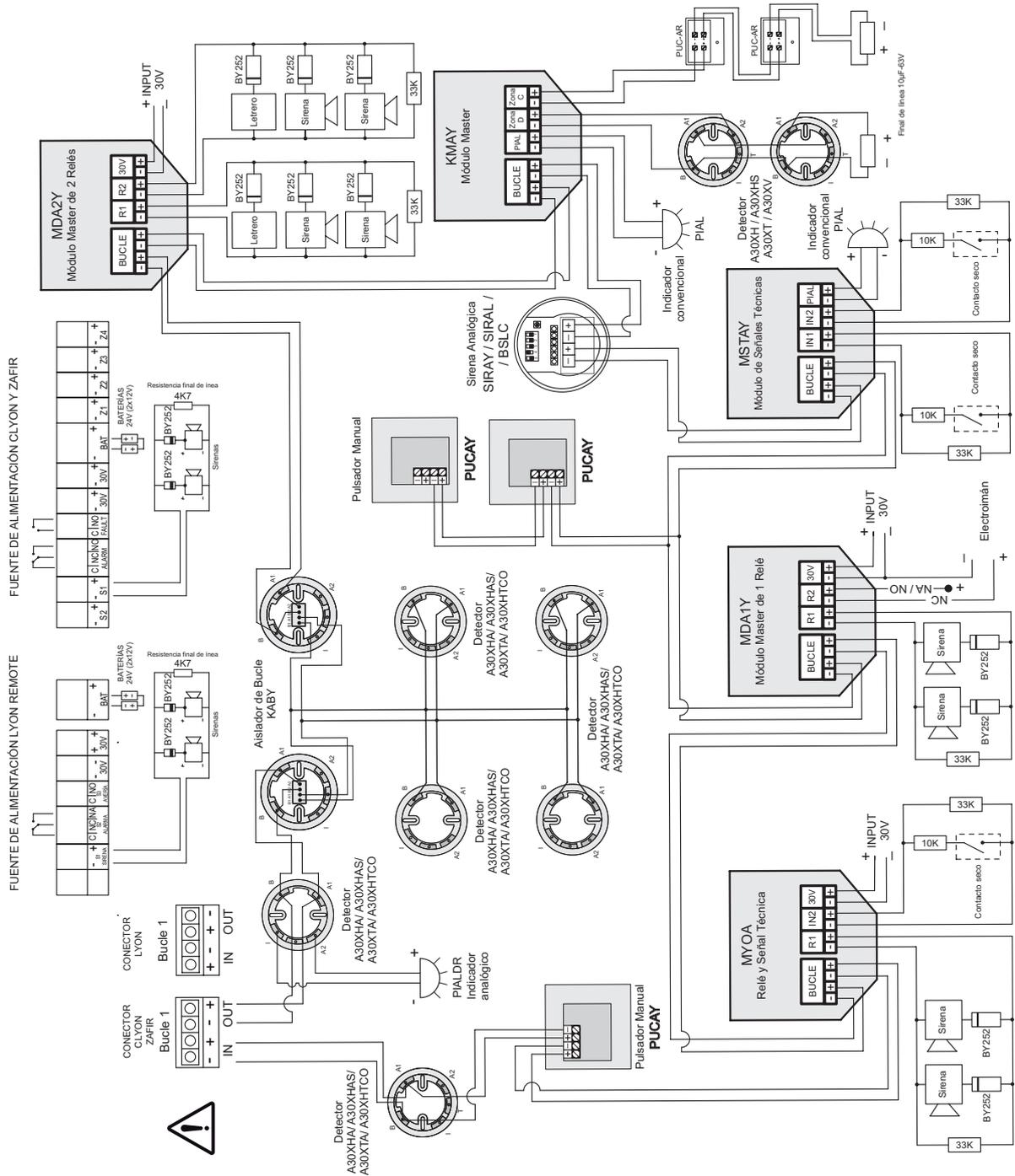
NOTA: Los esquemas indican la instalación de diodos en las sirenas. Si estas sirenas tienen diodo incorporado, no es necesario añadirlo.
