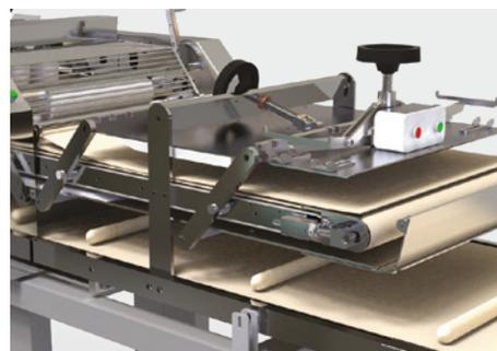
La formatrice modello FR25LUX è una macchina molto versatile con la quale è possibile ottenere la forma desiderata per ogni tipo di pane. Forme ottenibili: pane corto, pane lungo, baguette, con punte sottili, senza punte, ecc.
