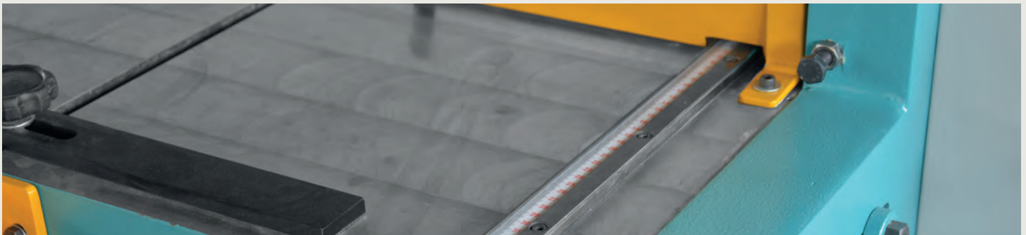
Taşlanmış Kesim Tablası Ground Table for Cutting
