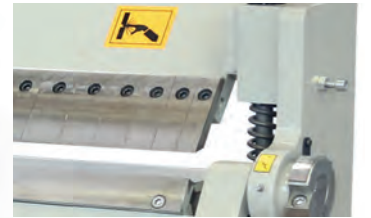
Yay destekli rahat büküm Spring supported easy folding
