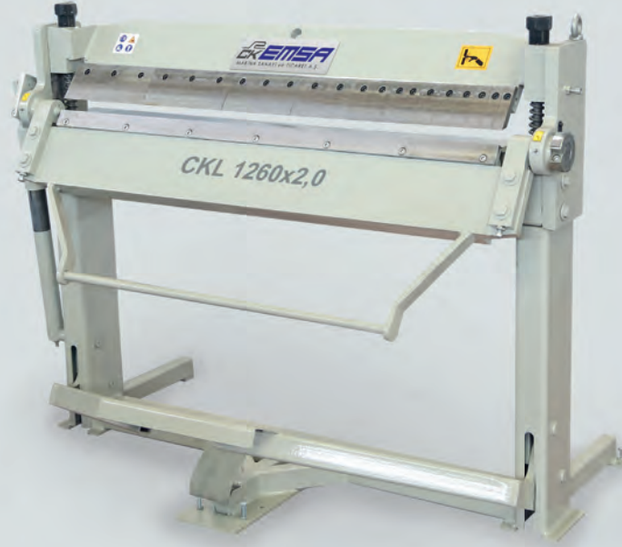
Kaliteli Çelikten Parçalı Bıçaklar Quality Steel Segmented Blades
