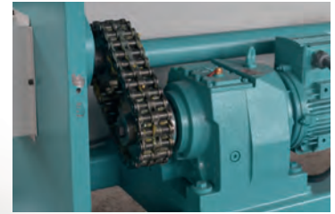
Redüktörlü Kesim Sistemi Gearbox Driven Cutting System
