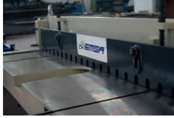
Döküm Taşlanmış tabla Cast Iron ground Table
