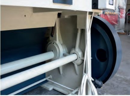
Döküm Gövde ve Ayaklar Cast Iron Body and Frames
