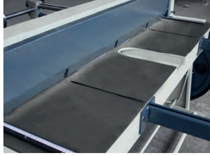
Döküm Taşlanmış tabla Cast Iron ground Table
