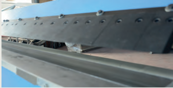
Standart Arkor Kaplamalı sert bıçaklar Standard Arcor Coated hard blades
