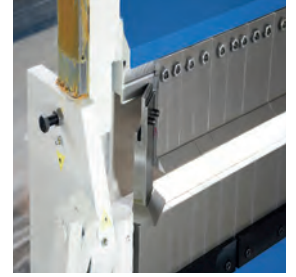
Alt ve Üst Bıçaklar Parçalı Pabuç tip Top & Bottom Blades Both Segmented Shoe Type
